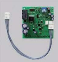
**Verstärker NVT801** mit regelbarem Transistorverstärker, zum Einbau in UP-Kasten, Versorgungsspannung 8-12V~, mit Steckkontakt für TLS/92
